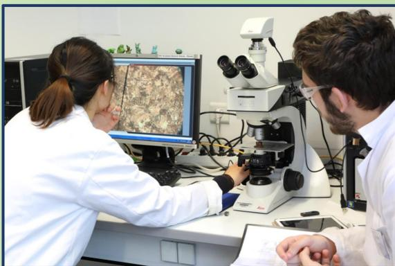
Etude de la microstructure des aciers à l'aide d'un microscope
