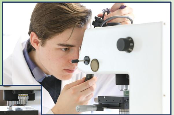
Utilisation d'un duromètre Vickers pour l'étude des propriétés du cuivre
