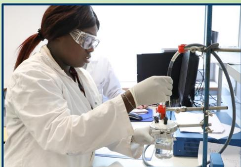
Mise en place des électrodes pour l'étude de la passivation des métaux
