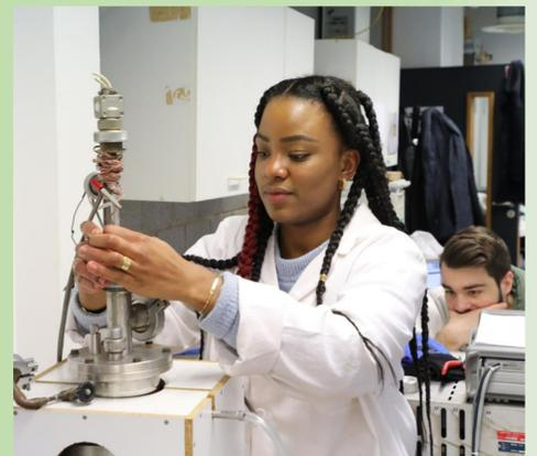
Réalisation de mesures de résistivité électrique à basse température.
